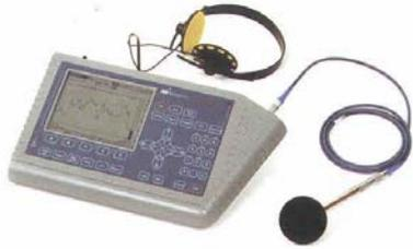
Zur Erfassung und Auswertung der Infrasschallwerte wurden Geräte und Software der Firma *Norsonic* verwendet.
